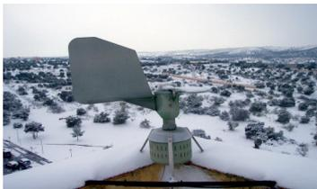
Captador Burkard 7 day spore (Figura 22) trap Hospital Virgen del Valle (Toledo) Figura 22
